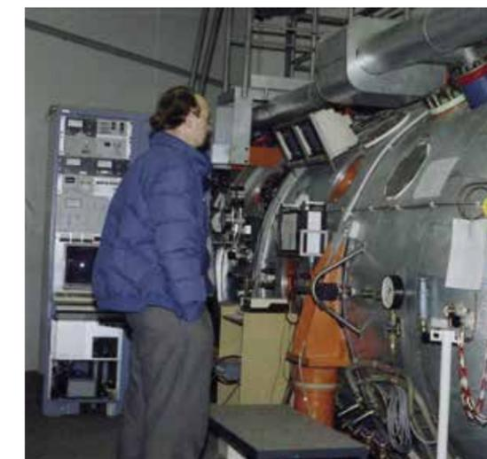
Mit der Anlage „TITAN“ konnten Tauchtiefen bis 1000 m und in einem angeschlossenen Wasserbecken sogar bis 1500 m simuliert werden
