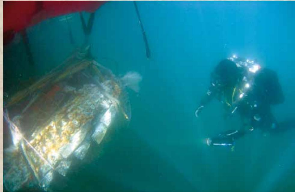
Nach 14 Tagen der Vorbereitungen konnte der Motor der Messerschmitt Bf109 geborgen werden. Lino von Gartzen neben dem 700 kg schweren DB601 Motor.
